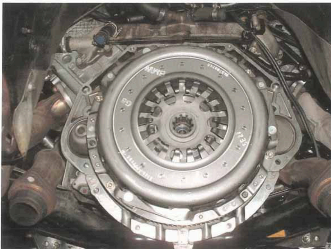
(写真10) クラッチ取付け状況
