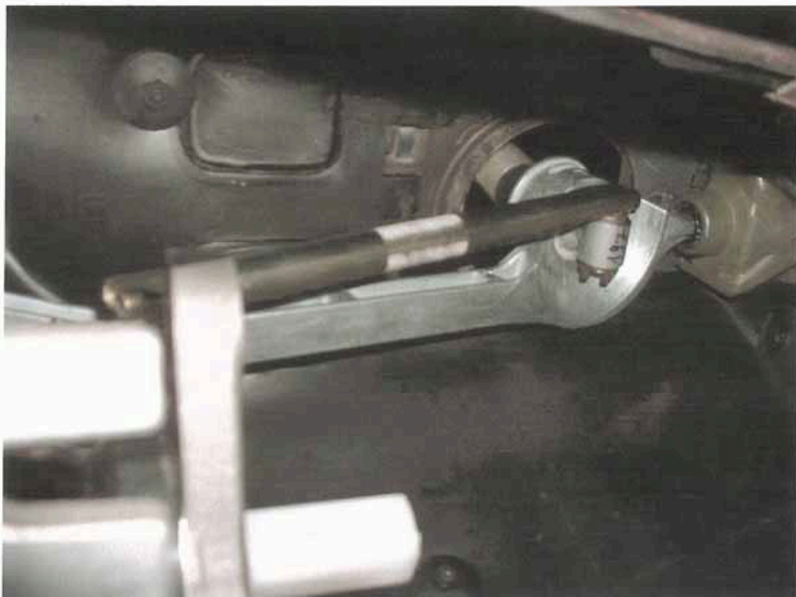
(写真8) シフトリンク機構組み付け状況2
