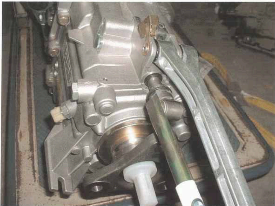
(写真7) シフトリンク機構組み付け状況1
