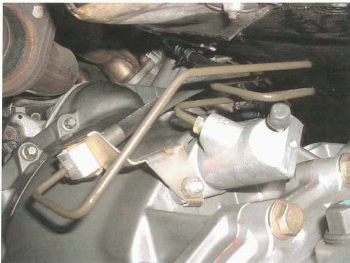
(写真 12) 油圧パイピング組み付け状況 1
